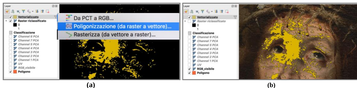
Figura 19-20-21 (a) Raster vettorializzato con lo strumento poligonizzatore. (b) Tracciato vettoriale tematizzato con sfondo immagine luce visibile.
